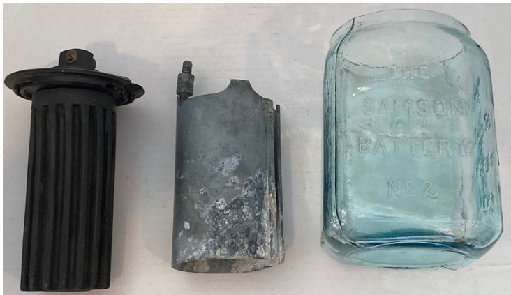
شکل ۱,۹: سلول اولیه سامسون با الکتروود کربنی و استوانه روی.
