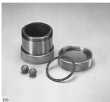
شکل ۲-۴: a - آسیاب نوع SPEX۸۰۰۰ و b - محفظه کاربید تنگستن به همراه گلوله و واشر جهت آب بندی آن
