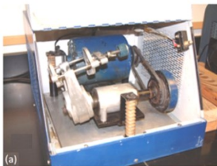
شکل ۲-۴: a - آسیاب نوع SPEX۸۰۰۰ و b - محفظه کاربید تنگستن به همراه گلوله و واشر جهت آب بندی آن
