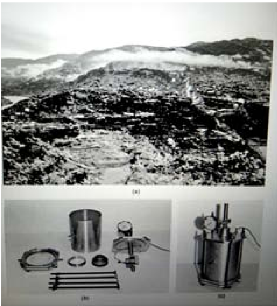
تصاویری که محتوای این قسمت ۱ را نشان می دهد: (a) زمین لغزش بزرگ در سال ۲۰۰۳ در امتداد مسیر سد سه دره؛ (b) اجزای حجمی یک بعدی اصلاح شده استخراج کننده صفحه فشار (Ng and Pang, 2000b); (c) مونتاژ اصلاح شده یک بعدی استخراج کننده صفحه فشار حجمی Pang, 2000b
